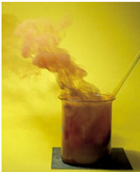
Gambar 10.9. Reaksi gas klor pada pembuatan \text{FeCl}_3
