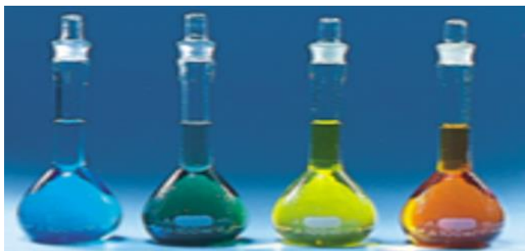
Gambar10.10. Larutan Beberapa Senyawa Yang Mengandung Ion Kromium. Dari kiri ke kanan Kromium (II) Klorida \text{CrCl}_2 berwarna biru, kromium (III) Klorida \text{CrCl}_3 berwarna hijau, Kalium Kromat \text{K}_2\text{CrO}_4 berwarna kuning dan Kalium Kromat \text{K}_2\text{Cr}_2\text{O}_7 berwarna orange.
