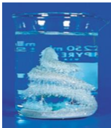
Gambar 10.12. Spiral tembaga dicelupkan dalam larutan perak nitrat
