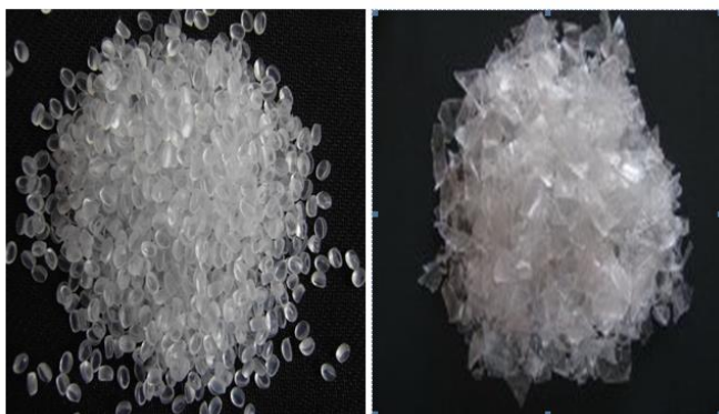
Gambar 13.15. a. Plastik polietilen. b. Plastik Poliethylene Terephtalat Sumber : https://pewicker.wordpress.com/tag/pe-wicker/
