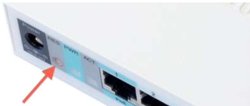
Untuk melakukan reset konfigurasi pada routerboard bisa dilakukan dengan langkah-langkah sebagai berikut :
